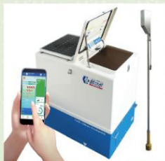
餌ロボ本体と超音波センサー部分（右）
