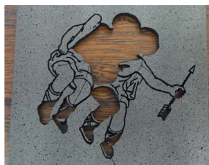
レーザー出力が強すぎた試作品
