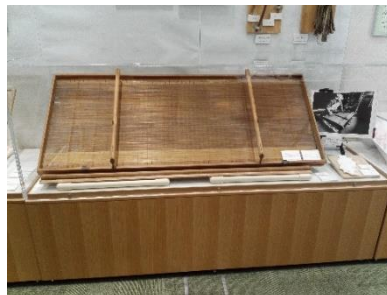
吉井源太によって改良された大型簾桁・萱簾・竹
