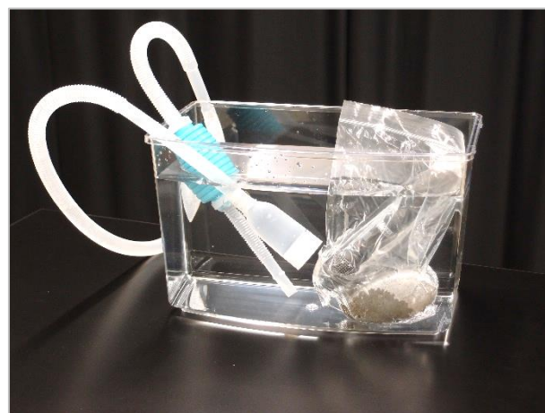
図6：チャックポリに入れ、水槽の水に沈めたマイク
